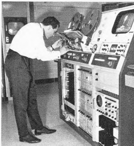
Bild 3. Der Verfasser bei der Inspektion der Aufnahme- und Wiedergabeköpfe einer Ampex-Anlage mit dem Mikroskop
