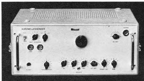
Rechts: Bild 1a. Der in ein Normgehäuse eingebaute Kurzwellensender macht einen industriemäßigen Eindruck. Mit dem linken unteren Knopf läßt sich der Trägerzusatz von außen einstellen
